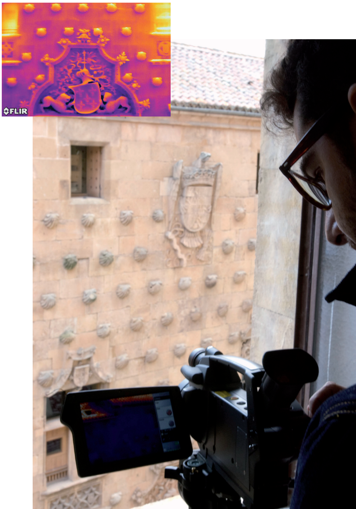
Imagen termográfica de la fachada de un inmueble histórico. Casa de las Conchas, Salamanca. Foto: Guillermo Enríquez de Salamanca. Archivo IPCE
